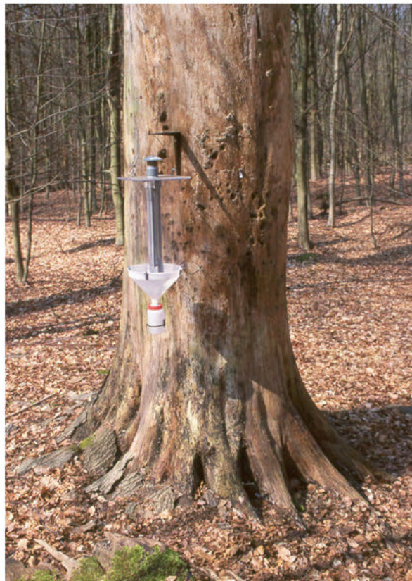
Fig. 6.2. : Overzicht van de proefopstelling bij de uitgebreide bemonstering niveau 3 : vensterval, lokval en open stameklektor (niet zichtbaar op de foto zijn 3 bodemvallen en 6 kleurvallen (3 witte en 3 gele) die in de buurt van de andere vallen worden opgesteld.
