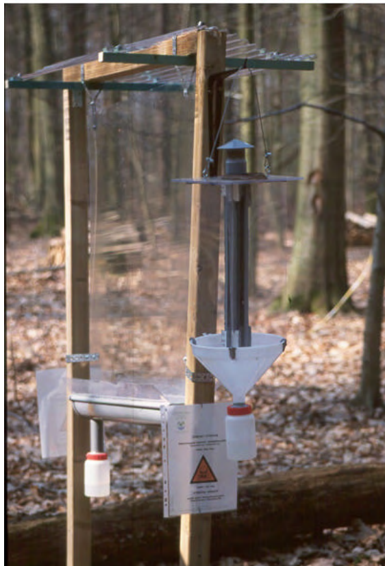
Fig. 6.2. : Overzicht van de proefopstelling bij de uitgebreide bemonstering niveau 3 : vensterval, lokval en open stameklektor (niet zichtbaar op de foto zijn 3 bodemvallen en 6 kleurvallen (3 witte en 3 gele) die in de buurt van de andere vallen worden opgesteld.
